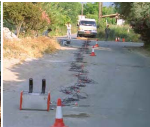
Γεωφυσική έρευνα: Εκτέλεση σεισμικής διασκόπησης (Αίγιο)
