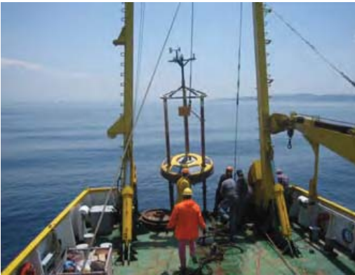
Πόντιση πλωτού μετρητικού σταθμού από το Ω/Σ Αιγαίο (πρόγραμμα ΠΟΣΕΙΔΩΝ)
