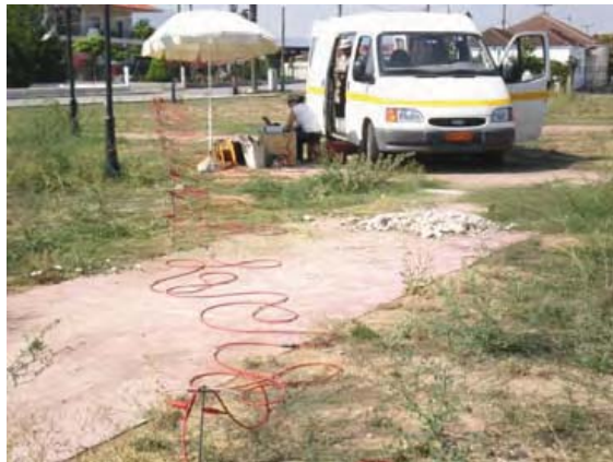
Γεωφυσική έρευνα: Εκτέλεση διασκόπησης ηλεκτρικής τομογραφίας (Λάρισα)
