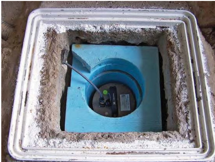
Σεισμολογικές Έρευνες: Εγκατάσταση σεισμομέτρων στην ύπαιθρο
