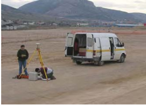
Γεωφυσική έρευνα: Εκτέλεση μετρήσεων Βαρυτικού Πεδίου και GPS (Θριάσιο Πεδίο, Αττική)
